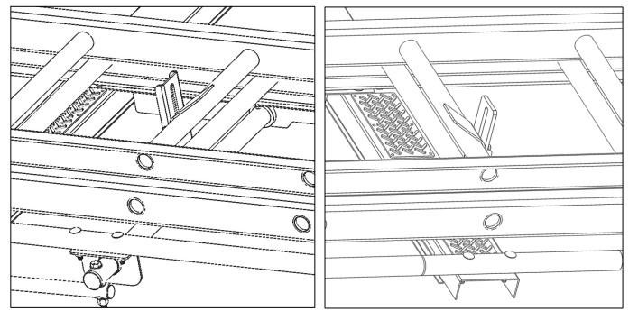
\*\* BE SURE THE LADDER HOOKS ARE FIRMLY AGAINST THE LADDER STEPS OR RUNGS. \*\*
